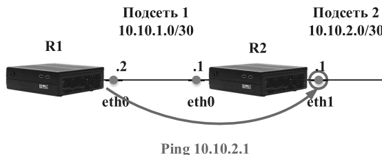
Рисунок 2. Проверка связности сети командой ping
