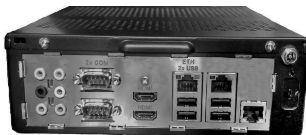
Рисунок 3.6. Системный блок ВК «Эльбрус 101-PC» — вид сзади
