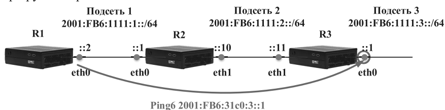
Рисунок 3. Проверка связности сети командой ping6
